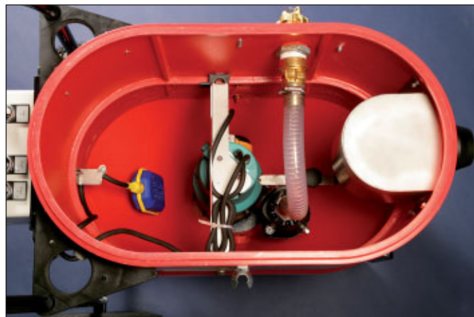
Binnenaanzicht met geplaatste pomp en vlotterschakelaar voor zuigmotor en pomp.
