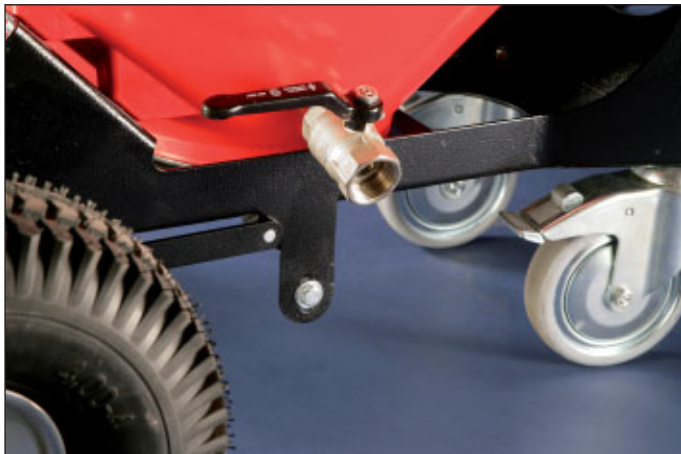
Zeer eenvoudige lediging van de zuiger door het openen van de kogelkraan en het aflaten van de vloeistof.
