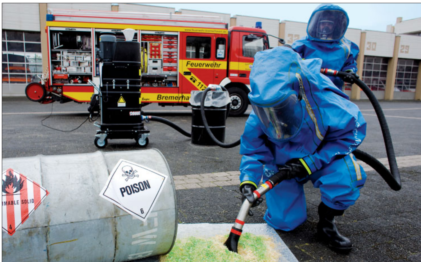
Einsatz der Feuerwehr Bremerhaven: Ruwacs DS 1400 II2G3D saugt ein, was gefährlich werden könnte
