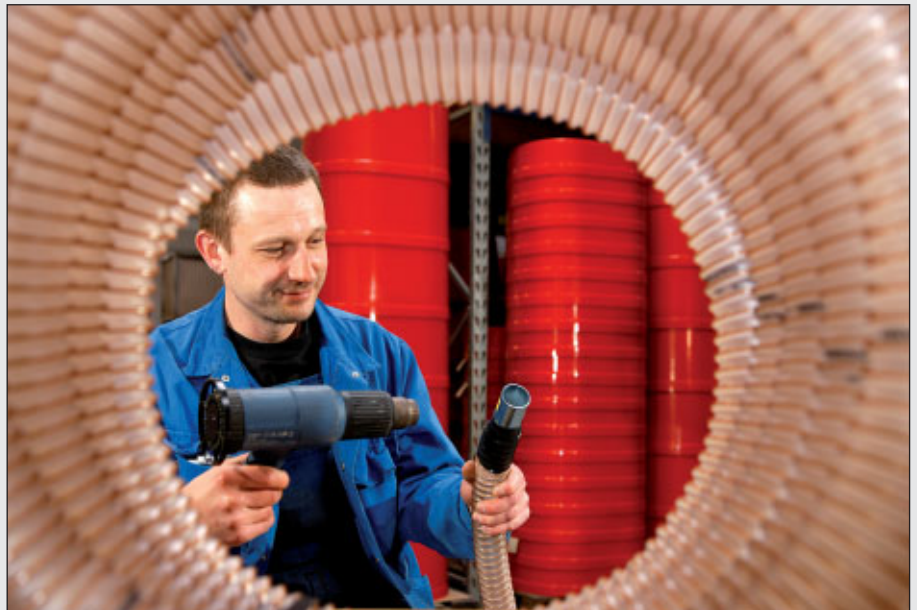
Leitet perfekt ab: Ruwac-Schlauch mit eingezogenem Draht für die Sicherheit
