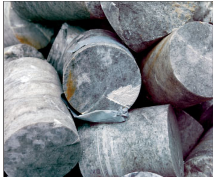
Bohrkerne, mit denen die Löcher wieder verschlossen werden
