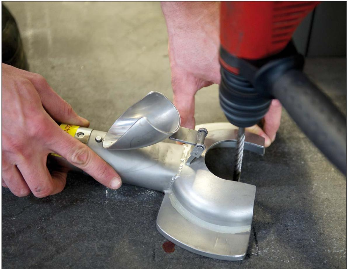
Bohrungen in gefährliches Terrain: eine Hilti und die Saugvorrichtung mit Schutzkappe, die Stücken entwickelt hat.
