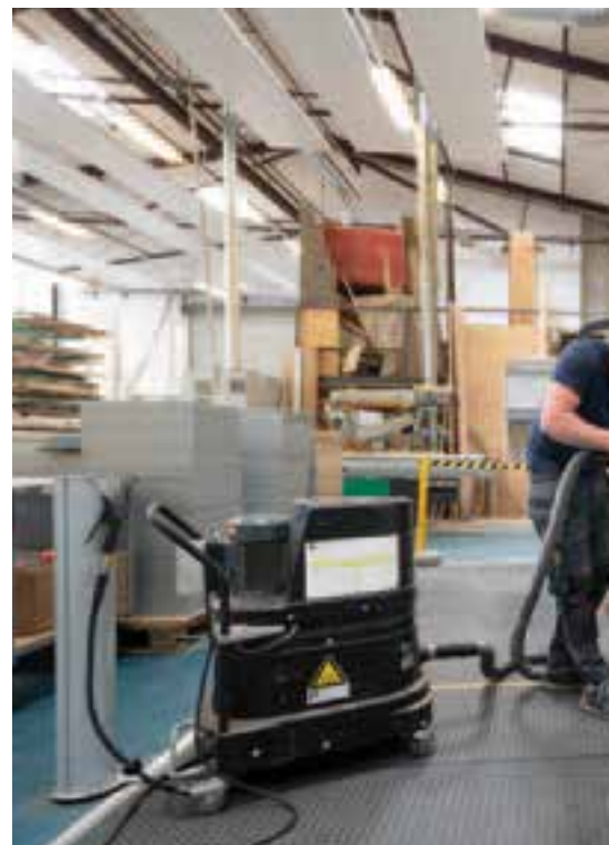
Ein DS 1220, Zone 22, noch mit altem „B1 - Bauart 1“ Aufleber reinigt die Holzfräse
