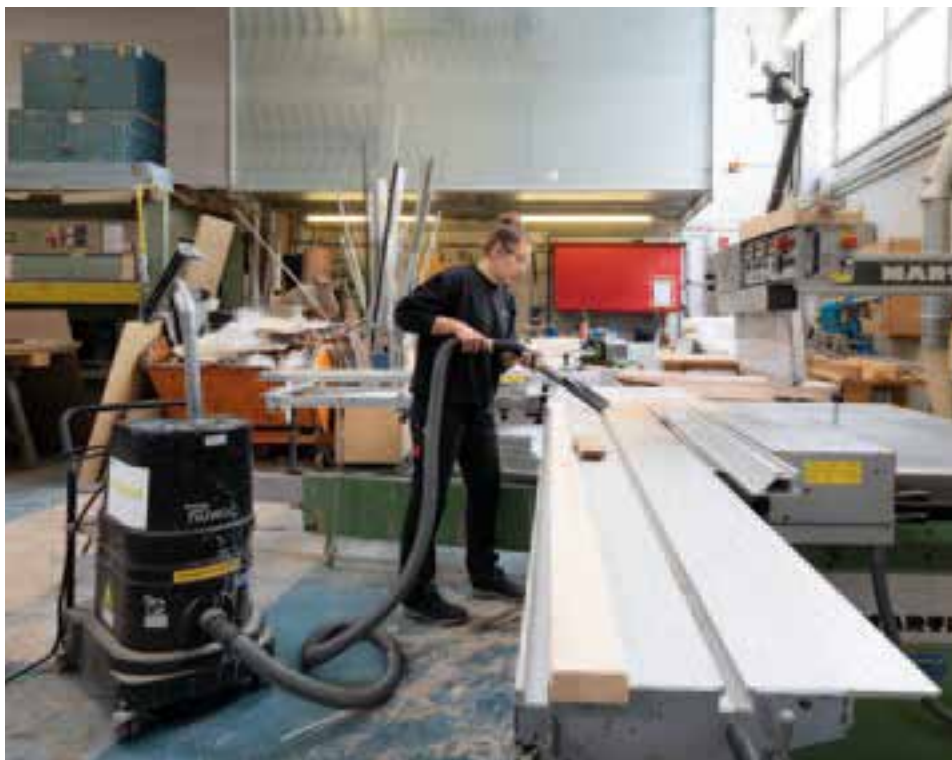
Ein DS 1220, Zone 22, saugt Holzstäube von der Holzsäge
